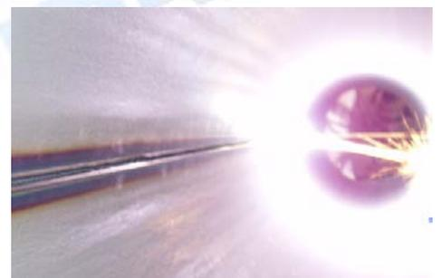
Das für runde und lineare Schweißnähte verwendete PAW-System (Plasmaschweißen) erlaubt die vollständige Durchdringung auch von dicken Materialien.
